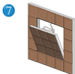
7 Insertar la puerta con los pernos dirigidos hacia abajo, encajándolos en las perforaciones del marco exterior. Enganchar el cable de seguridad y cerrar la trampilla. El cable de seguridad debe quedar cerrado, después utilizar la trampilla.
