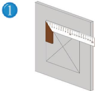
1 Medir el marco exterior y con ayuda de una falsa escuadra dibujar el perfil de la apertura sobre la pared en el cual la trampilla será instalada. (dimensiones de la trampilla + 5 mm)
