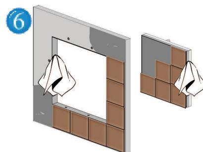
6 Aplicar el pegante para baldosas a ras del marco sobre la pared y sobre la compuerta de la trampilla, dejándolos visibles y aplicar las baldosas. Limpiar los dos marcos (interior y exterior) si quedan residuos. Es muy importante limpiar siempre los marcos durante el montaje para evitar problemas de funcionalidad de la trampilla.
