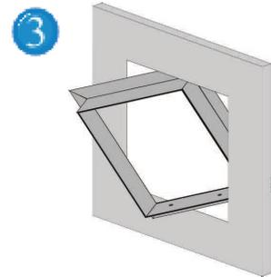
3 Insertar el marco exterior de la trampilla en la apertura, haciéndolo girar en diagonal hacia el interior del corte realizado. Los click de cierre deben quedar en la parte superior.
