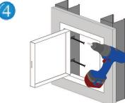
Insertar el marco en la pared o el techo desde la parte anterior y atornillar las garras de sujeción (abiertas) a los perfiles en C.
