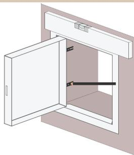
Sujetar la trampilla abierta y con las garras de sujeción abiertas, insertarla desde la parte anterior.
