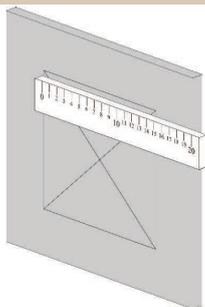
Medir el marco exterior y con el auxilio de una falsa escuadra y dibujar el perfil de la apertura sobre la pared (o el techo) donde será instalada la trampilla (dimensiones de la trampilla + 5 mm).
