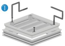
Entfernen Sie die Befestigungsschrauben und nehmen Sie den Innendeckel mit Hilfe der Hebeschlüssel aus dem Außenrahmen.
